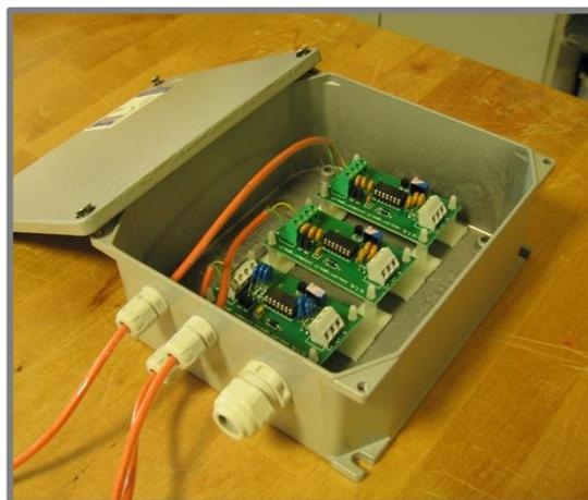
4-20 mA signal converter (n. 3 transducers set-up)
